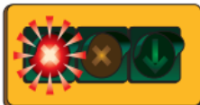
Controlesignaal: Geplaatst boven rijstroken om aan te geven welke open zijn om te rijden. Hier: ROOD = niet rijden op rechterrajstrook.
